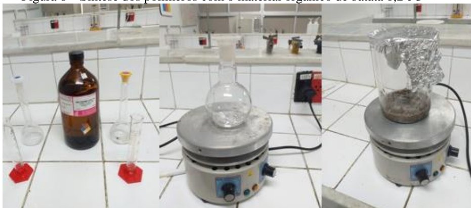
Figura 6 – Síntese dos polimeros com o material orgânico de batata 1,2 e 3
