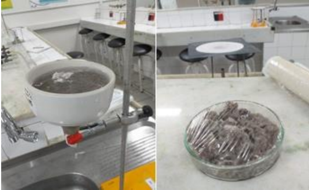
Figura 7 – Filtragem, Lavagem e obtenção de uma massa polimérica híbrida
