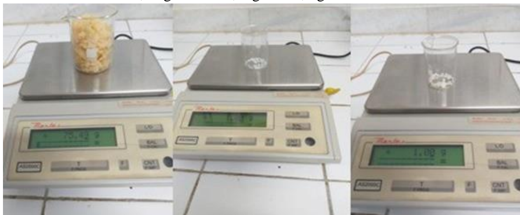
Figura 5 – Pesagens das Massas 75,49 g de batata, 1 g de PS, 1g de MB
