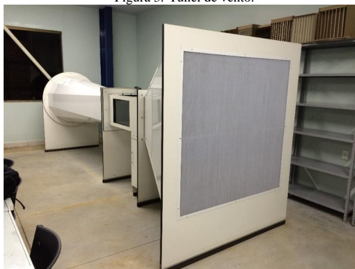
Figura 3: Túnel de vento.
