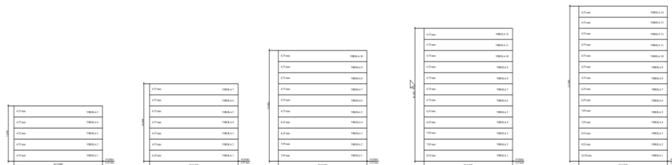
Figura 6: Dimensões dos tanques e espessuras das virolas.
