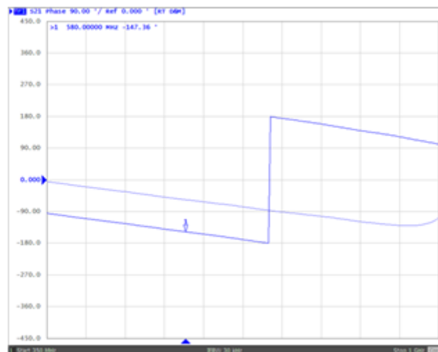
Fig. 8. Medida da diferença de fases entre saídas em protótipo de h = 1.6\text{mm}
