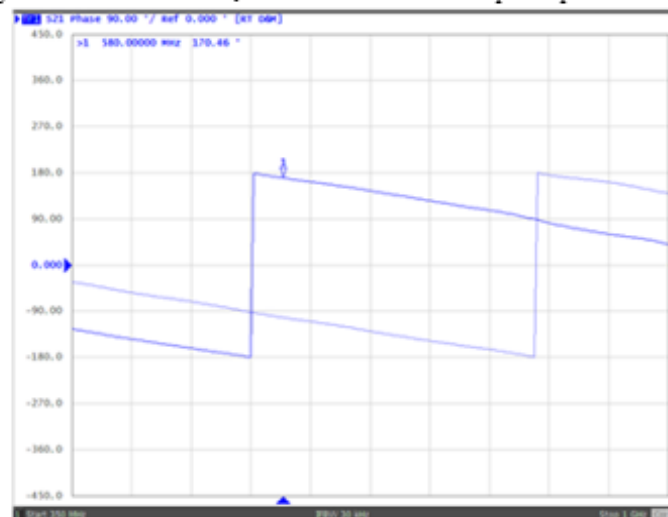
Fig. 14. Medida da diferença de fases entre saídas em protótipo de h = 4.8\text{mm}
