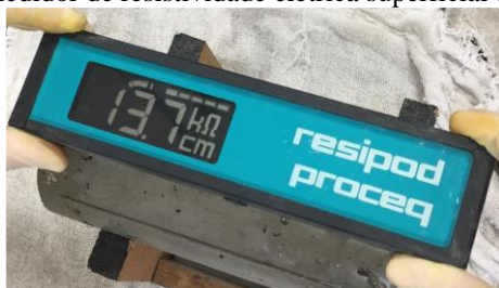
Figura 3: Medidor de resistividade elétrica superficial da PROCEQ
