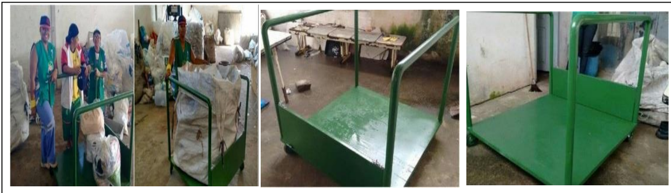
Figura 7 – Protótipo real do carrinho plataforma para transporte e entrega para as catadoras.
