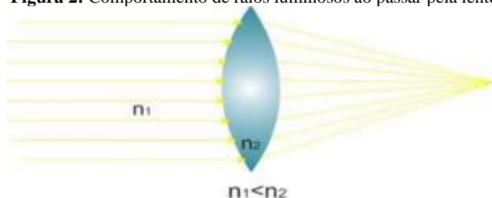
Figura 2: Comportamento de raios luminosos ao passar pela lente.
