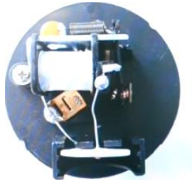
Figura 4 - Circuito interno do relé fotoelétrico.
