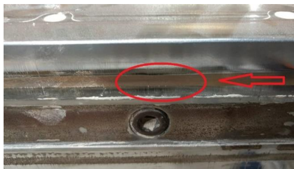
Figura 5: Lastrina com desgaste abrasivo (Dos autores, 2019).
