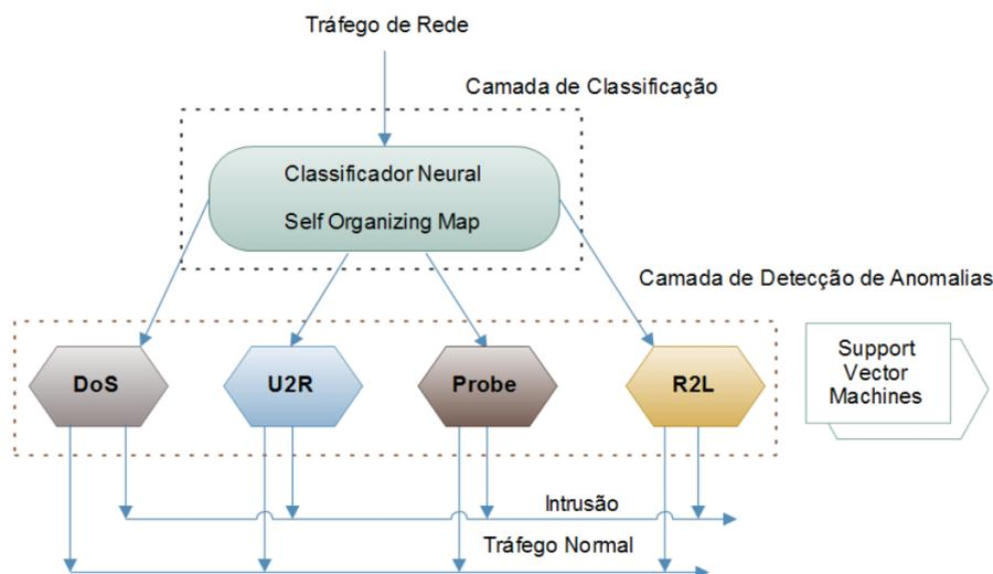
Realizada a classificação pela primeira camada, a saída da Rede SOM é enviada para a camada de Detecção de Anomalias especialista no potencial ataque detectado e esta SVM, que é responsável pela detecção precisa das anomalias, determina se o pacote detectado realmente corresponde a um ataque ou é tráfego normal. Observando a Figura 1 pode-se perceber este fluxo descrito anteriormente.
