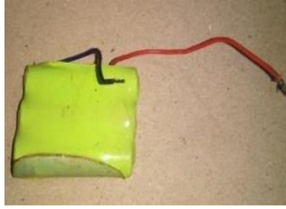
Figura 5. Bateria usada para armazenar a energia proveniente da placa.
