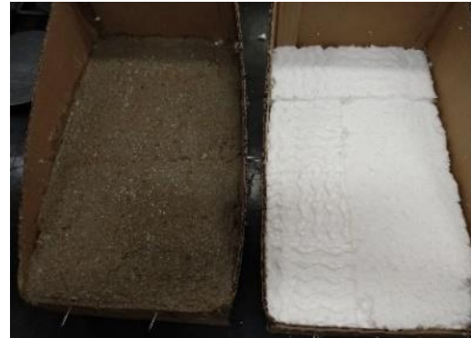
(d) Detalhe da aplicação da camada argamassa sobreposta ao EPS.
