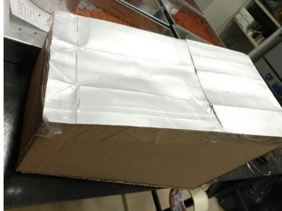
Figura 3 – Maquete com isolamento térmico aplicado.
