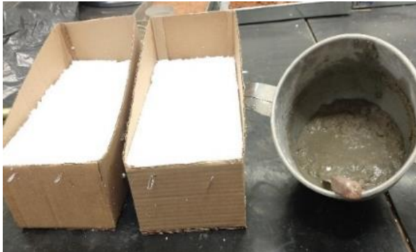
(c) Preparação da argamassa para cobertura da laje EPS.
