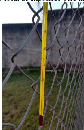
Figura 5 – Termômetro usado no local de exposição para medidas de temperaturas ambiente.
