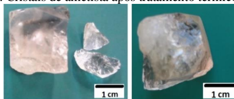
Figura 2. Cristais de ametista após tratamento térmico a 300°C.
