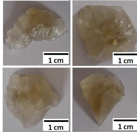
Figura 3. Cristais de ametista após tratamento térmico a 350°C.
