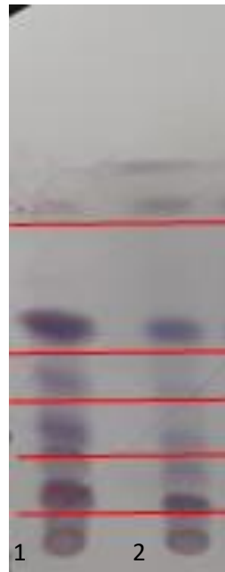
Figura 1. Cromatograma obtido por CCD de amostras de extratos hidroetanólicos de geopropolis, analisadas após aplicação do revelador químico anisaldeído sulfúrico. 1 = EHGv; 2 = EHGP.
