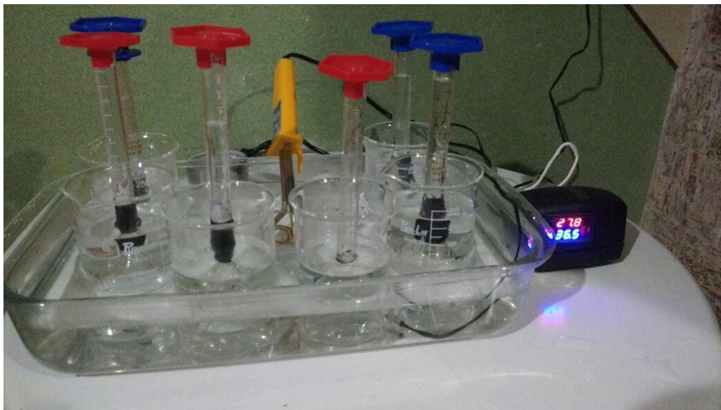
Figura 2 - Aparato para acompanhamento da evolução do hidrogênio.
