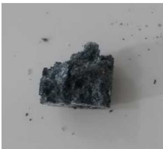
Figura 5 – Amostra da liga M2 recolhida após 120 horas em solução de Kokubo.
