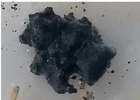
Figura 4 – Amostra da liga M3 recolhida após 72 horas em solução de Kokubo.
