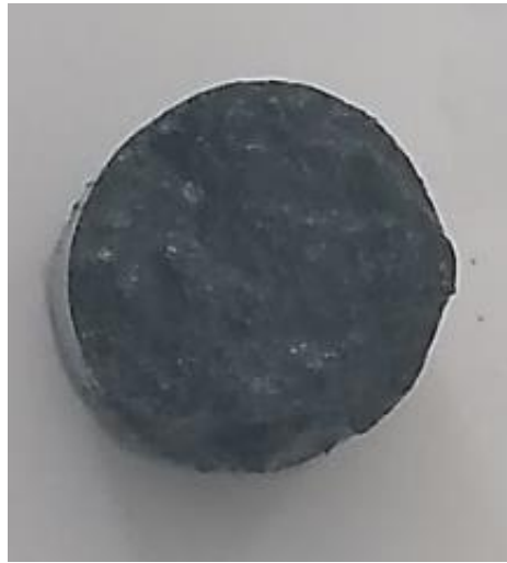
Figura 6 – Amostra da liga M1 recolhida após 240 horas em solução de Kokubo.
