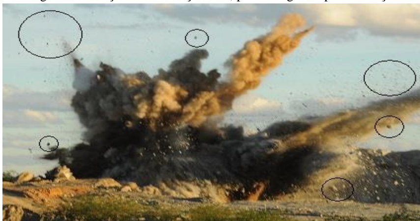
Figura 1– Geração de ultralancamento, poeiras e gases após detonação
