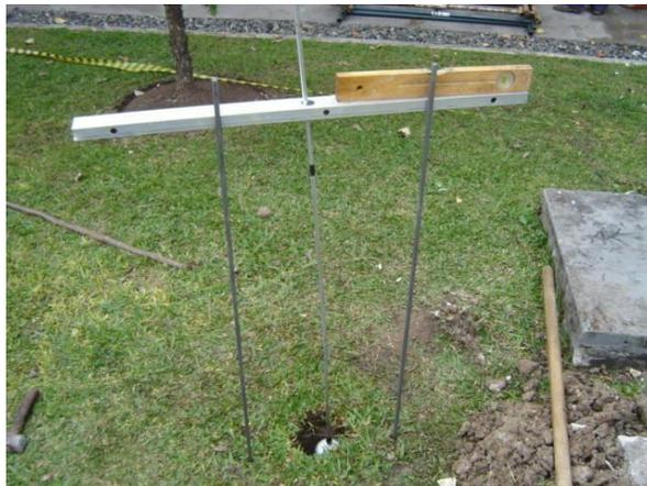
Cada uma das covas cilíndricas foi preenchida com água, tendo sido mantidas com igual nível durante 4 horas. Na Cova cilíndrica número 1, o nível da água baixava muito lentamente, enquanto nas covas cilíndricas de números 2 e 3, os níveis da água rebaixaram logo após o enchimento, sendo que a sua estabilização, de forma lenta, ocorreu nos últimos instantes das 4 horas de observações.
