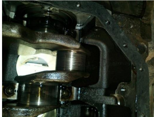
Figura 4: Eixo virabrequim desgastado.
