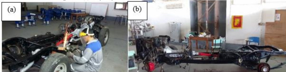
Figura 5: (a) Preparação da bancada. (b) Bancada didática finalizada
