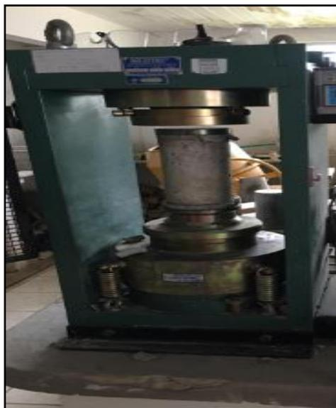
Destaca-se que a máquina disponível no LABCOM para a realização deste ensaio é destinada ao rompimento de corpos de prova cilíndricos, portanto, passou por uma adaptação com a finalidade de romper as peças de concreto para pavimentação (figura 12).
