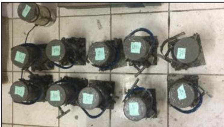
Figura 10 - Execução e moldagem das peças. (A): mesa vibratória e formas de plástico para as peças de concreto (B): concreto na forma. (Autor (2018)).
