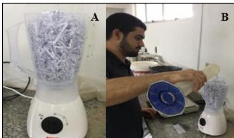
Logo após, a pasta foi peneirada até que toda a água presente saísse para que não afetasse a relação água-cimento do concreto. É válido destacar que como o papel possui uma grande capacidade de absorção de água, depois que foi peneirado houve a necessidade de
